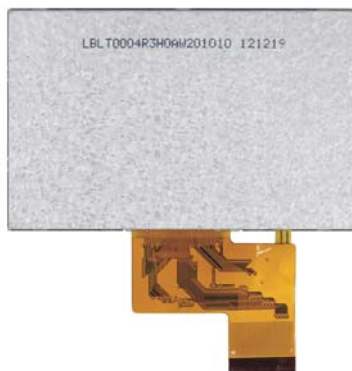
pohled zezadu - dot. panel rezistivní
