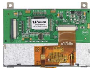
pohled zezadu - dot. panel rezistivní
